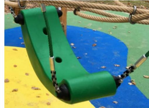
Die großen Kunststoffteile bestehen aus 100 % recyclebarem Kunststoff (PE). Der Schalensitz ist in einem Stück formgepresst und aus mindestens 5 mm dicken Wänden gefertigt. Das Material ist besonders beständig gegenüber Kälte und Hitze sowie Vandalismus.
