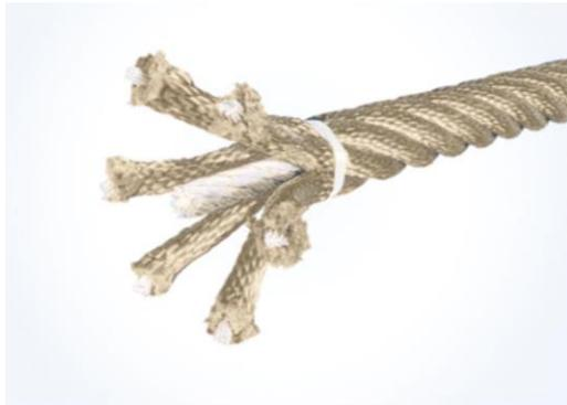
16 mm Corocord-Seile werden mit der Hercules-Technik gefertigt und bestehen aus verzinkten, verlitzigen Stahldrahtseilen, die mit einem Stahlkern versehen sind. Jede Litze ist mit PES-Garn umwickelt, das induktiv aufgeschmolzen wird. Damit sind die Seile besonders beständig gegenüber Abnutzung und Vandalismus. Corocord-Seile können jederzeit vor Ort ausgetauscht werden.
